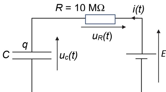
**2.1.** Montrer que l'équation différentielle vérifiée par la tension aux bornes du condensateur peut s'écrire :
