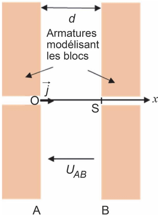
L'ensemble constitué par une cavité et deux blocs adjacents peut être modélisé par un condensateur plan (voir schéma ci-dessus) relié à un générateur délivrant une tension continue  $U_{AB} = 1 \text{ kV}$ .
