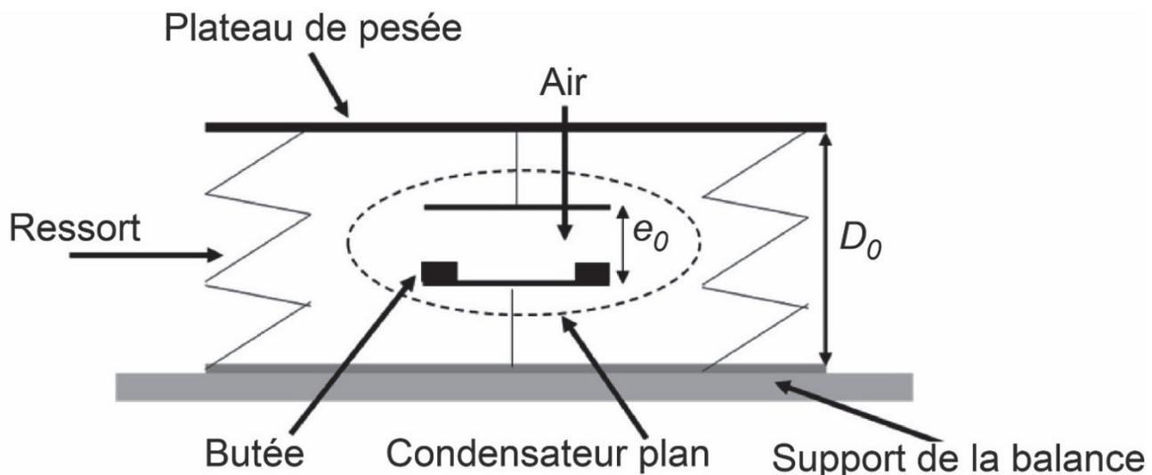
Lorsque la balance est à vide (sans masse sur le plateau), la distance entre les deux armatures est notée  $e_0$ . Lorsqu'un objet de masse  $M$  est posé sur le plateau de pesée, les armatures du condensateur se rapprochent, modifiant alors la valeur de sa capacité  $C$ . Les deux armatures ne peuvent pas entrer en contact grâce à la présence de petites butées de taille négligeable devant  $e_0$ .
