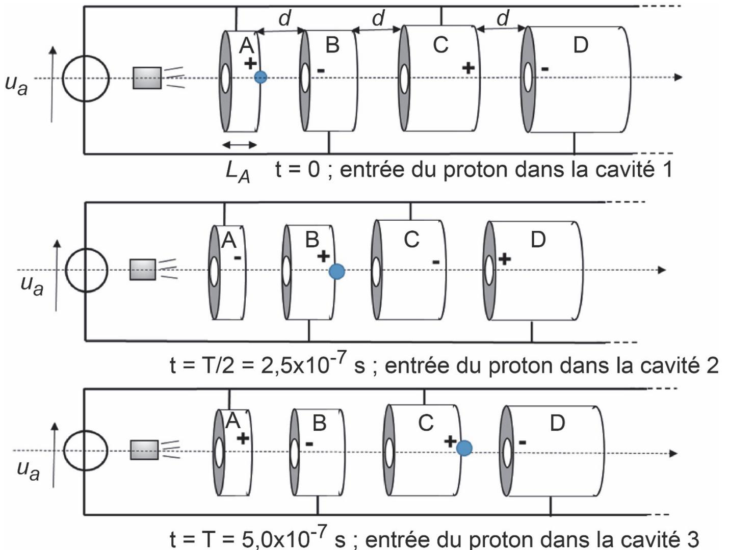
On note  $d$  la distance entre deux blocs,  $L_A$  la longueur bloc A,  $L_B$  la longueur du bloc B, etc.
