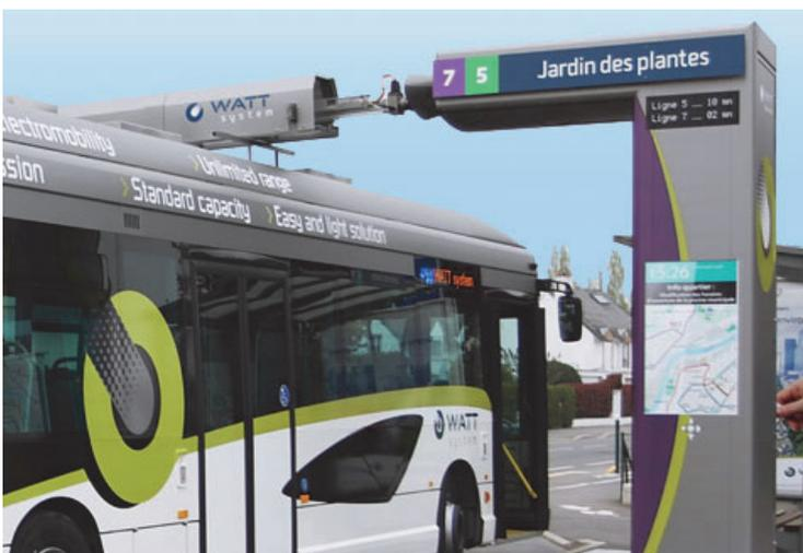
Le principe est le suivant : à chaque arrêt, le bus se connecte de manière automatique et rapide au totem. Le transfert d'énergie électrique entre les supercondensateurs du totem et les supercondensateurs embarqués dans le bus s'effectue alors en environ 10 s. Cette phase, appelée « biberonnage », doit être parfaitement sécurisée. En effet, l'intensité du courant électrique peut atteindre plusieurs milliers d'ampères en début de transfert.
