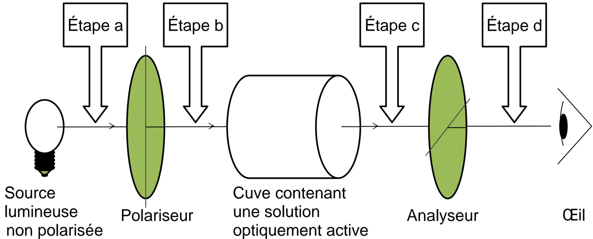
Les orientations du polariseur et de l'analyseur croisés sont orthogonales. Dans ces conditions, en l'absence de solution optiquement active, aucune lumière n'émerge du polarimètre.
