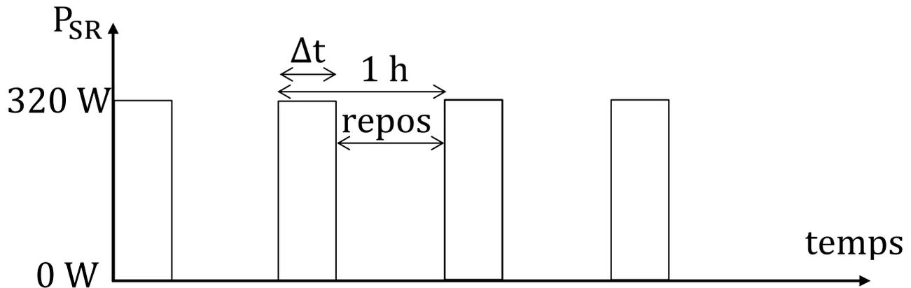
Sur 1 h, le système de refroidissement ne fonctionne que pendant une durée  $\Delta t$ , sinon il est à l'arrêt.
