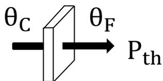
La puissance thermique  $P_{th}$  au travers d'une paroi de résistance thermique  $R_{th}$  soumise de part et d'autre à des températures  $\theta_C$  et  $\theta_F$  ( $\theta_C > \theta_F$ ) est telle que :
