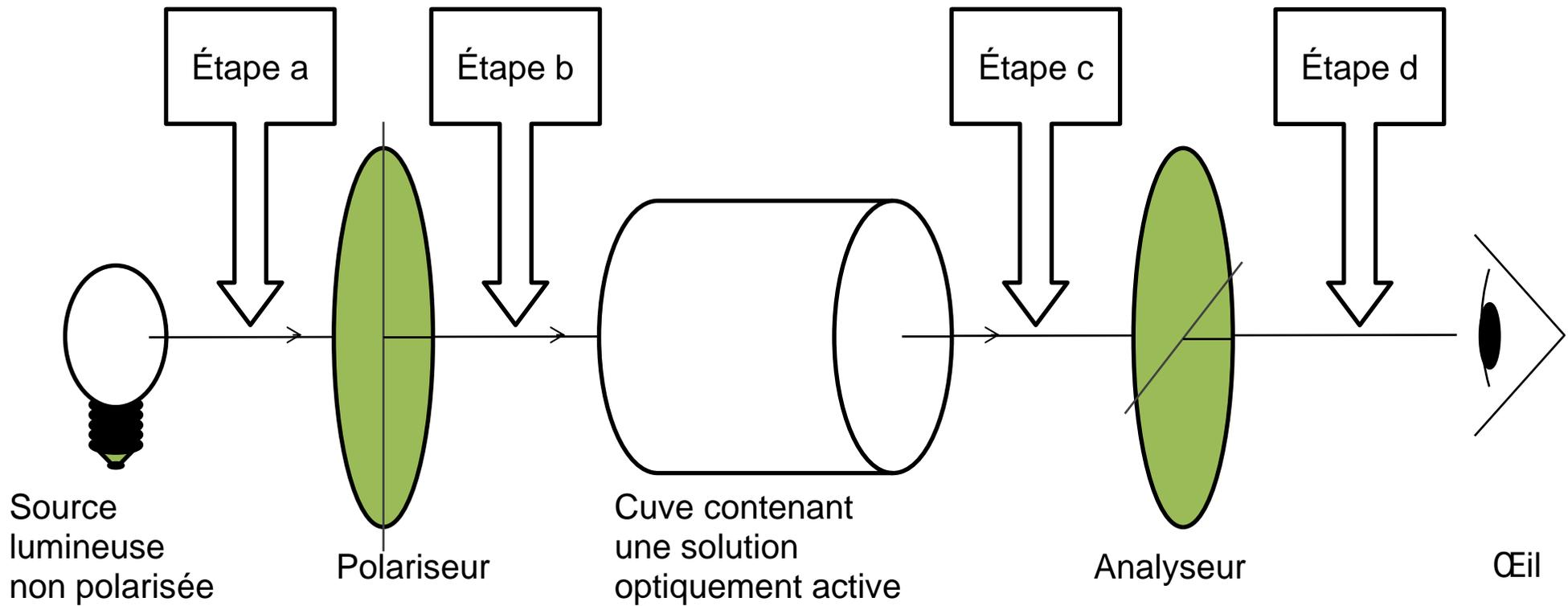
Les orientations du polariseur et de l'analyseur croisés sont orthogonales. Dans ces conditions, en l'absence de solution optiquement active, aucune lumière n'émerge du polarimètre.
