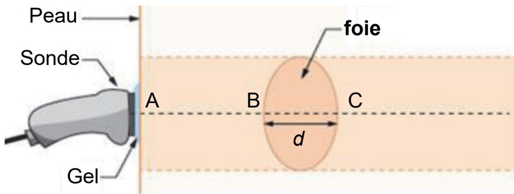
Les ultrasons émis par la sonde se réfléchissent aux points B et C qui déterminent la taille du foie. Le signal détecté par la sonde est représenté ci-dessous. Le signal repéré par la lettre « b » correspond à la réception, par la sonde, du signal réfléchi au point B.
