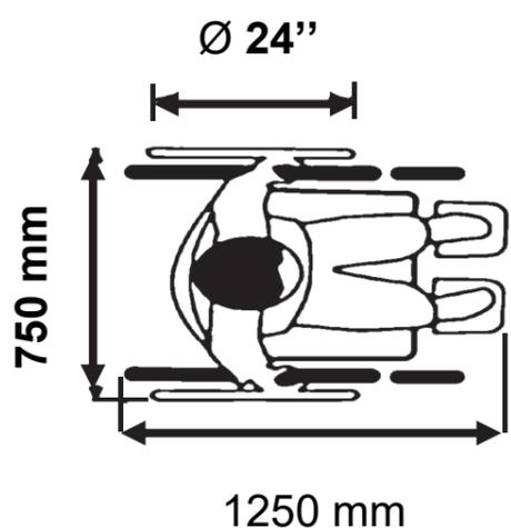
La figure ci-dessus donne le gabarit d'encombrement d'un fauteuil roulant. Une roue arrière de fauteuil a un diamètre de 24" (pouces), soit 610 mm.
