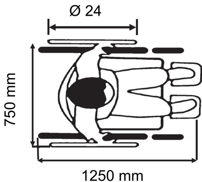
La figure page précédente donne le gabarit d'encombrement d'un fauteuil roulant. Une roue arrière de fauteuil a un diamètre de 24" (pouces), soit 610 mm.
