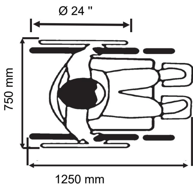
La figure page agrandie précédente donne le gabarit d'encombrement d'un fauteuil roulant. Une roue arrière de fauteuil a un diamètre de 24" (pouces), soit 610 mm.
