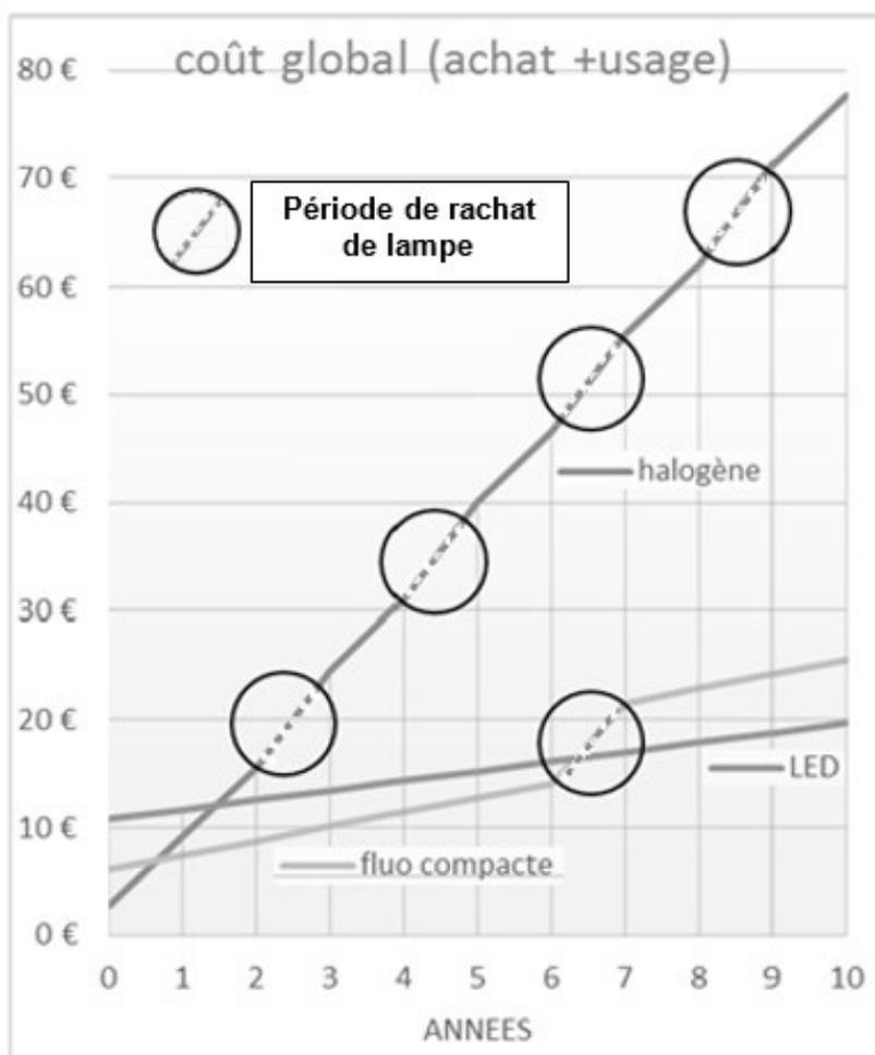
Calcul des coûts d'utilisation de lampes LED (DEL) de 6 watt, équivalente aux anciennes lampes de 60 Watt – Source ADEME (Agence de l'Environnement et de la Maîtrise de l'Energie)
