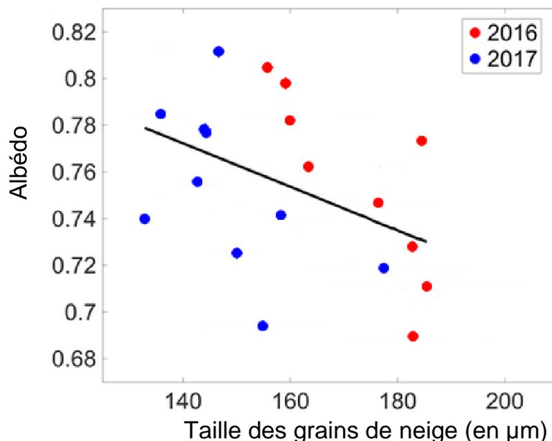
La courbe de tendance présentée ci-dessus a été obtenue à partir de mesures réalisées au Groenland dans des « fosses à neige », dispositif expérimental mis en place pour l'étude. La corrélation établie ici, entre albédo et la taille des grains de neige, est statistiquement significative.
