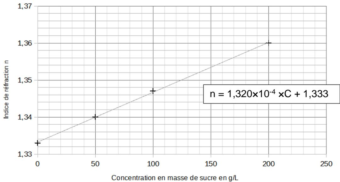
On mesure l'indice de réfraction du moût. Le réfractomètre indique  $n = 1,348$ .
