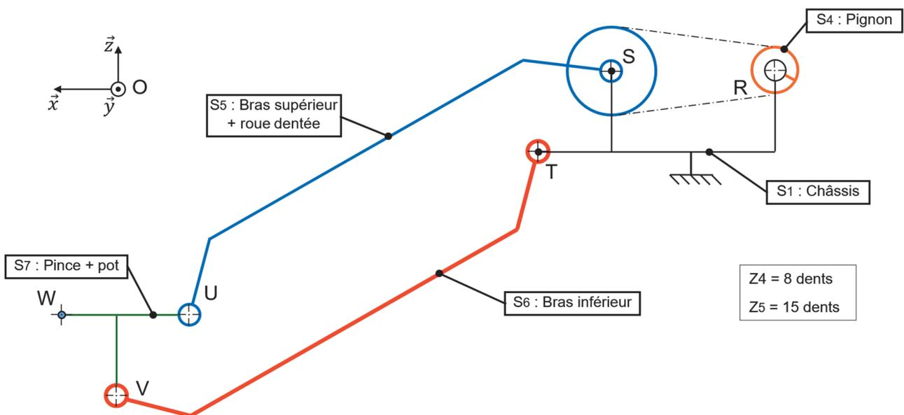
Figure 8 : schéma cinématique du système de levage dans le plan  $(O, \vec{z}, \vec{x})$
