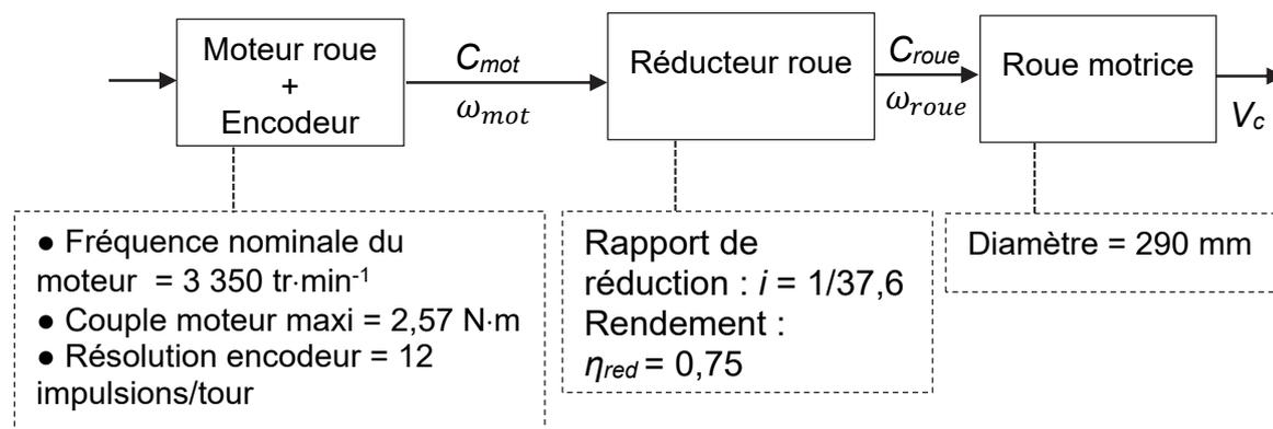
Figure 4 : chaîne de puissance de la base mobile
