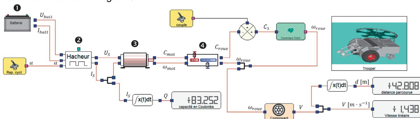
Figure 6 : modélisation multiphysique de la chaîne de puissance
