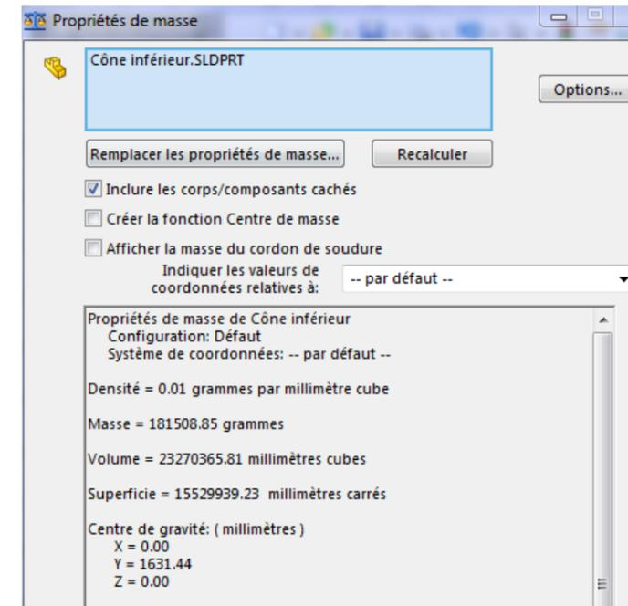
**Question 5 :** Déterminer la masse  $M_{(2.12a+2.12b)}$  en kg du tronc de cône.
