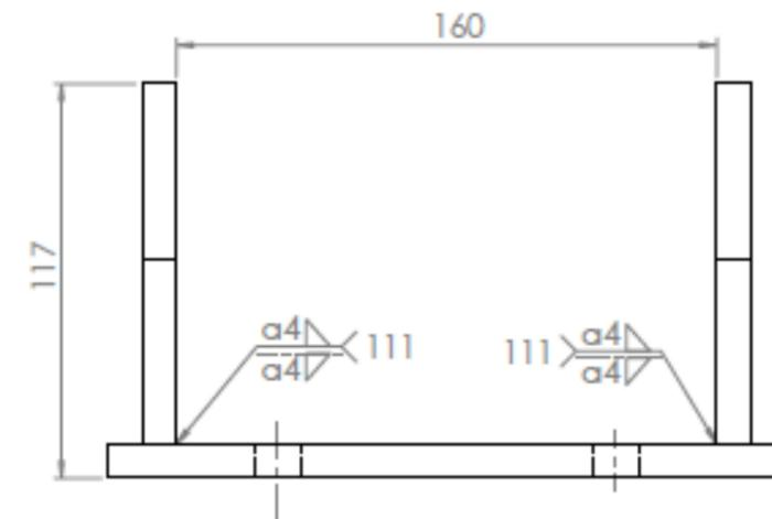
**Problématique** : vous êtes chargé de préparer la commande matière de 200 sous-ensembles charpente SE3, c'est-à-dire de rédiger les fiches de débits et de calculer les mises en barre.
