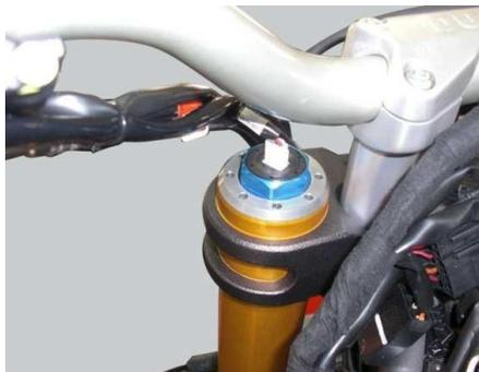
Extrémité supérieure du tube gauche de la fourche, dans lequel le moteur électrique pas à pas agissant sur le frein hydraulique en compression est installé.
