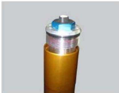
Desserrer le contre-écrou du bouchon supérieur de retenue du plongeur
