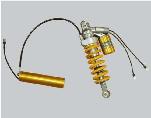
L'image montre l'amortisseur arrière Öhlins avec les fils (à droite) utilisés pour porter l'alimentation aux actionneurs électriques. Ceux-ci modifient les freins hydrauliques présents dans le conduit qui met en communication le volume du tuyau de l'amortisseur avec le réservoir. La pompe électrique de la presse hydraulique se trouve à gauche, tandis que l'actionneur hydraulique se trouve sur le ressort dont il en modifie la précontrainte.
