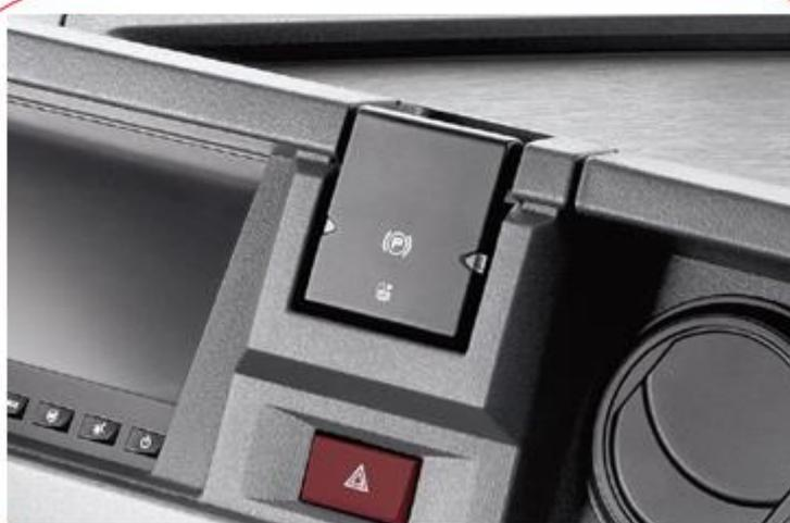
Le frein de parc électrique (EPB : Electronic Park Brake) est monté en série sur la gamme Renault T. Cette fonction est gérée par l'APM 2 (Air Product Modulator 2<sup>ème</sup> génération).
