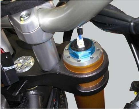
Extrémité supérieure du tube droit de la fourche, dans lequel le moteur électrique pas à pas agissant sur le frein hydraulique en détente est installé.
