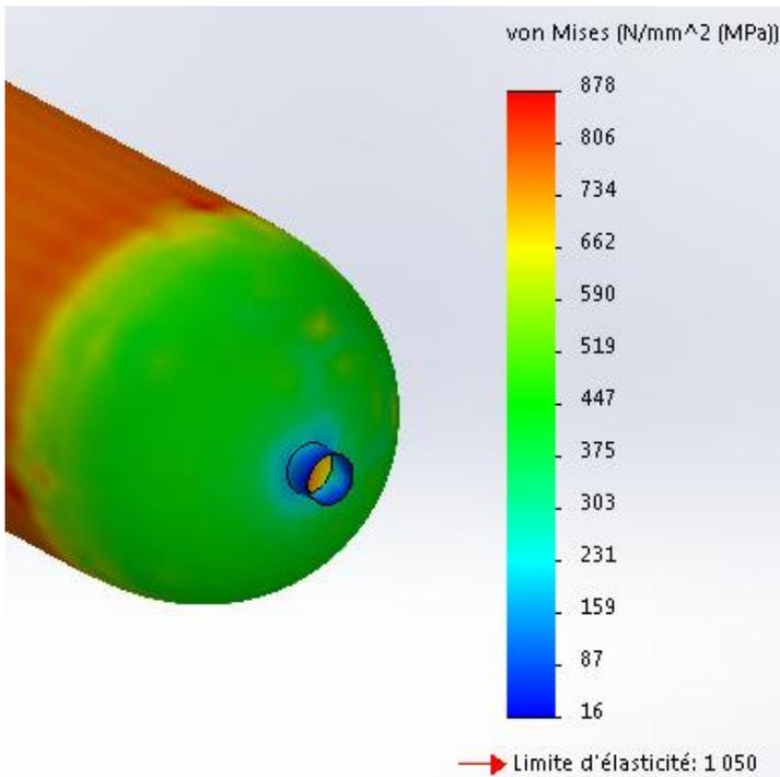
**8 mm Composite Epoxy / fibre de carbone**
