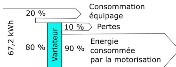
Question 3.5 | À partir du diagramme précédent, **calculer** l'énergie effectivement utilisée par la motorisation pour la propulsion.
