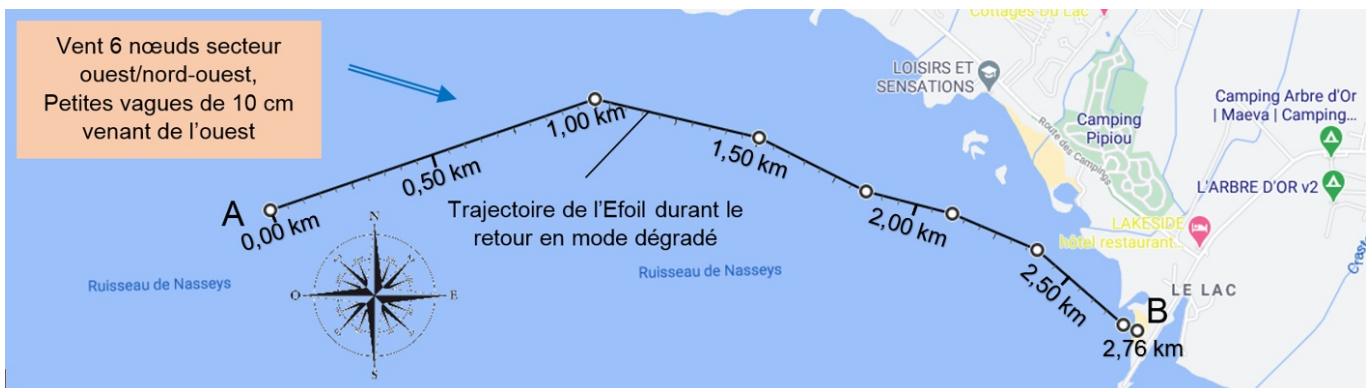
figure 10 - Relevé de l'enregistrement d'un essai réel en mode dégradé
