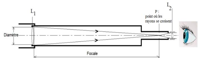
Le principe de cet instrument est de collecter la lumière émise par les astres, de la concentrer et de renvoyer à l'œil une image agrandie de l'objet observé.
