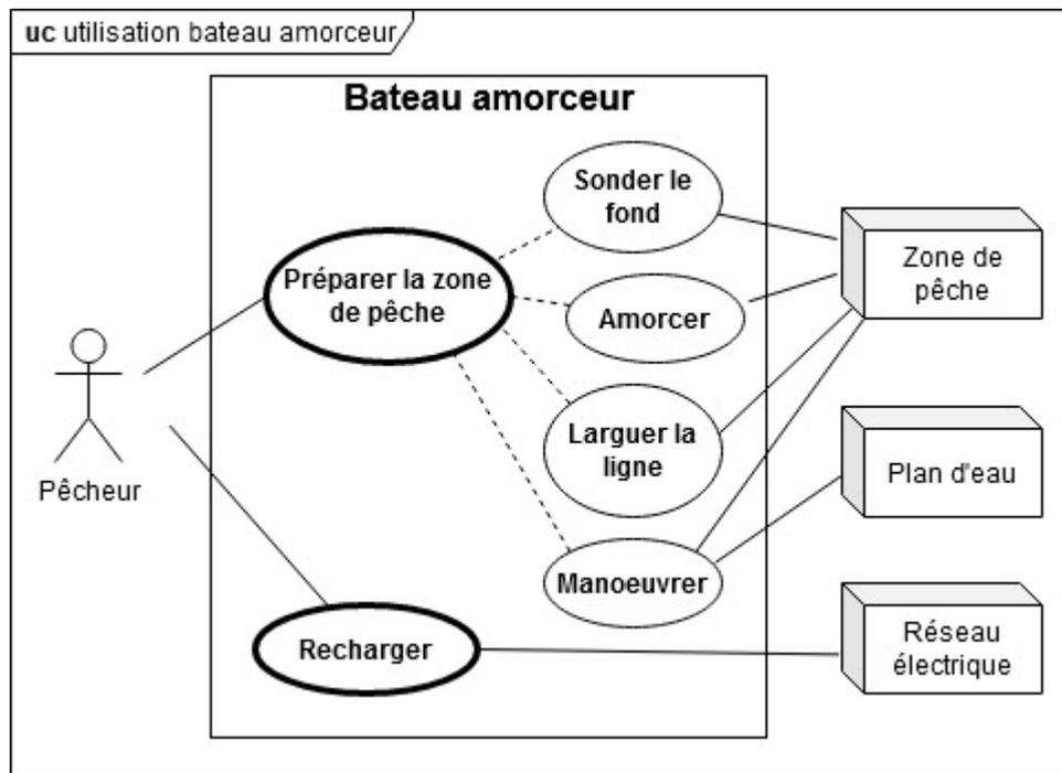
figure 1 : diagramme de cas d'utilisation du bateau amorceur
