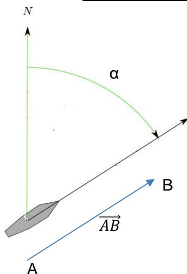
Le calculateur détermine tous les caps à suivre et l'ensemble des points GPS à atteindre. Pour rappel, le cap est la direction vers laquelle est orienté le bateau. C'est l'angle  $\alpha$  exprimé en degrés (de 0 à 360°), dans le sens des aiguilles d'une montre, entre la direction du nord et sa ligne de foi (son axe longitudinal).
