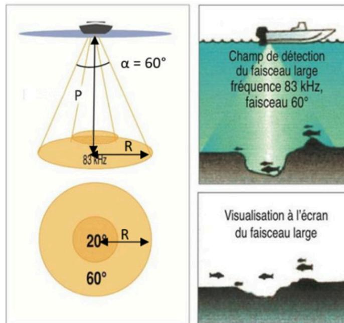
figure 15 : champ de détection de l'échosondeur
