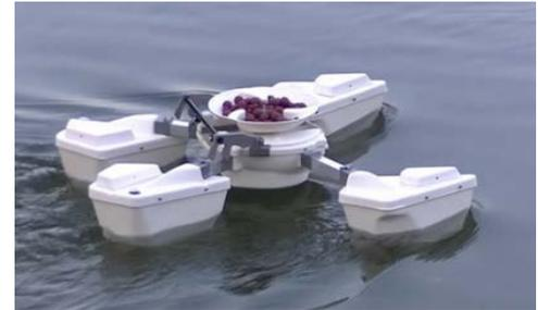
C'est un bateau télécommandé permettant d'aller déposer de 0,5 à 5 kg d'amorces, de façon très précise, dans des endroits difficiles et à longue distance (jusqu'à 300 m). Certains modèles possèdent un sondeur intégré ainsi qu'un GPS.
