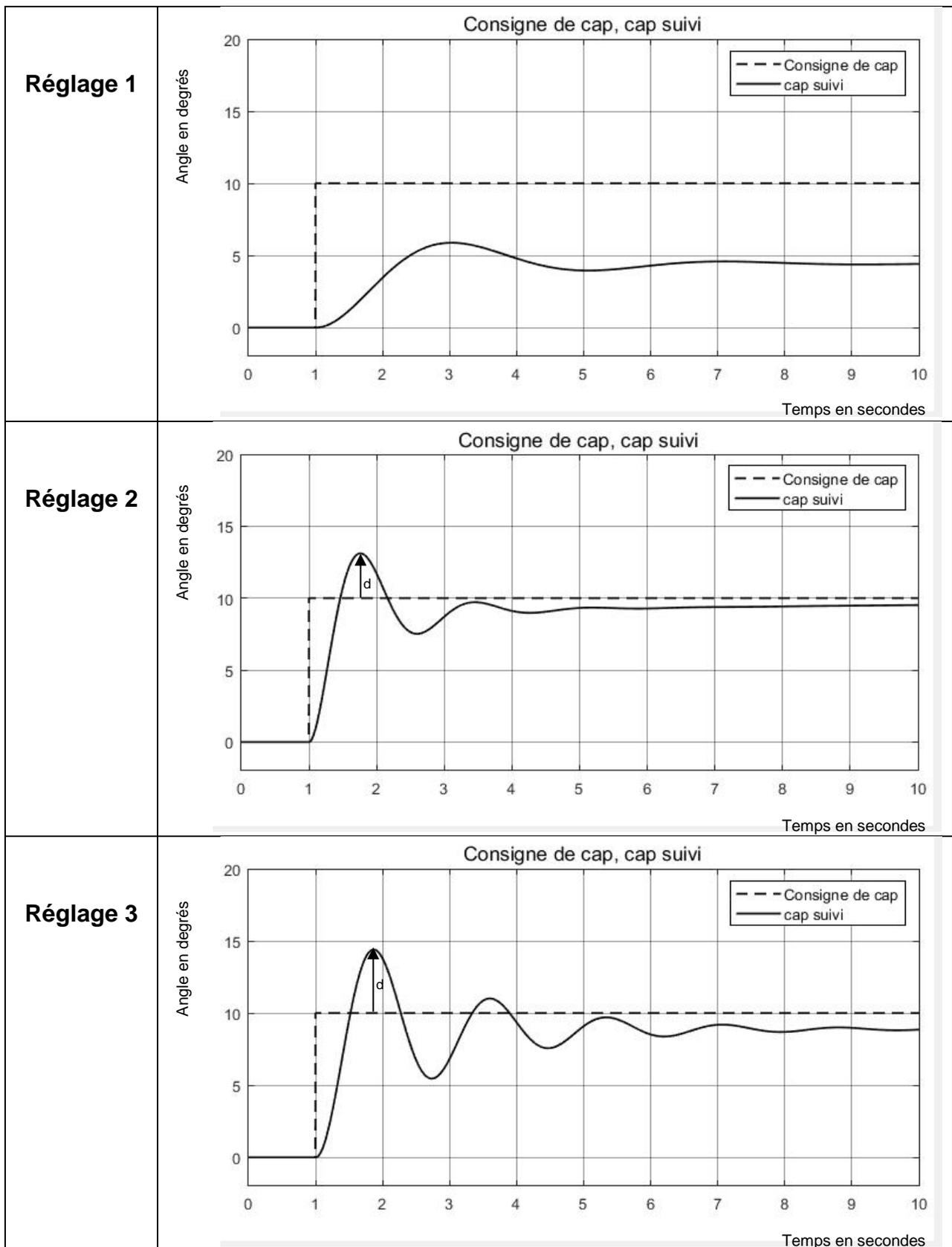
figure 12 : réponse du système à une consigne de type échelon pour différents réglages du correcteur proportionnel-intégral
