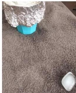
Expérience initiale avec à gauche un glaçon dans un verre couvert avec de l'aluminium et à droite, un glaçon sans aluminium posé sur une serviette en coton.
