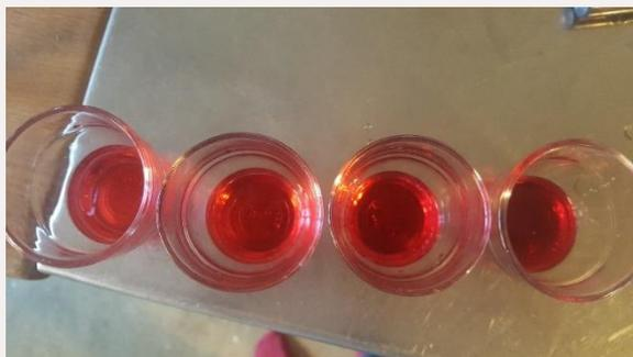
L'absorbance que je trouve sur ces solutions, avec le colorimètre est de -0,8 pour la solution diluée quatre-vingts fois, -0,4 pour la solution diluée soixante fois, 0,6 pour la solution diluée quarante fois et 0,21 pour la solution diluée vingt fois.
