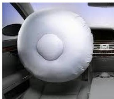
Lors d'un choc violent, une étincelle déclenche la décomposition de l'azoture de sodium  $\text{NaN}_3(\text{s})$  présent dans l'airbag en sodium  $\text{Na}(\text{s})$  et en diazote  $\text{N}_2(\text{g})$  selon la réaction chimique d'équation :
