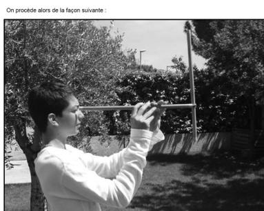
Viser l'élément à mesurer en avançant ou en reculant de sorte à faire coïncider le haut et le bas de la croix du bûcheron avec le haut et le bas de l'élément.
