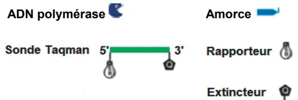
Une sonde TaqMan™, complémentaire d'une séquence ciblée du brin 3'→ 5' de l'ADN, contient une molécule fluorescente appelée « rapporteur » au niveau de son extrémité 5' et une molécule appelée « extincteur » au niveau de son extrémité 3'.
