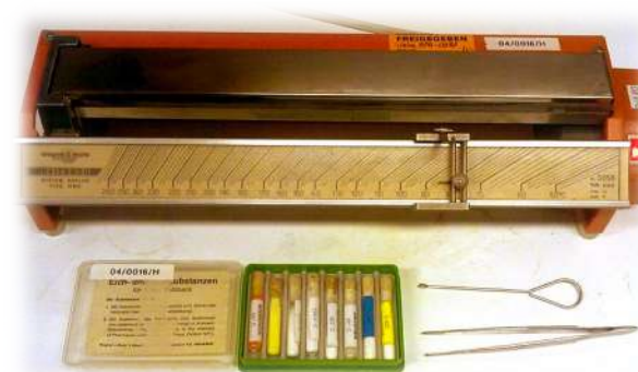
Banc Kofler pour mesure de la température de fusion
