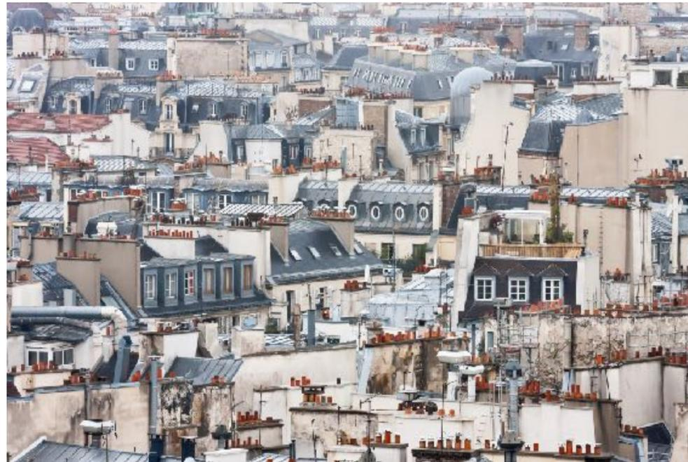
Le zinc, en réagissant avec le dioxygène de l'air, conduit à la formation d'une couche protectrice qui empêche la corrosion de se poursuivre, ce qui explique la longévité de ce matériau.
