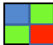
Groupement de quatre photosites correspondant à un pixel sur l'image.
