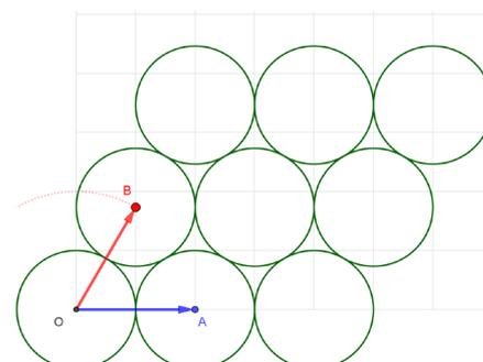
À partir du disque inférieur gauche centré à l'origine, un empilement est construit par deux translations de vecteurs  $\vec{u}$  et  $\vec{v}$  respectivement bleu et rouge.
