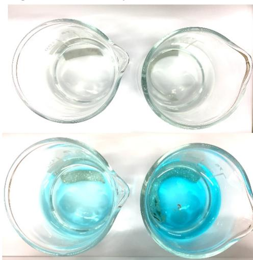
*Comparaison de l'aspect du système à l'état initial (en haut) et final (en bas) pour la transformation 1 (à gauche) et pour la transformation 2 (à droite).*
