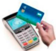
certains objets sont dits passifs c'est à dire qu'ils puisent leur énergie sur un autre élément du réseau. C'est principalement le cas des objets sans contact de type RFID et NFC.
