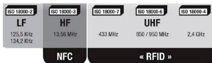
La première génération de rfid s'appuie exclusivement sur l'utilisation radio en basses fréquences appelées aussi LF pour Low Frequency à 125 et 134 kHz.
