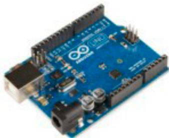
L'architecture basée sur un microcontrôleur est la plus économe en énergie mais elle est également moins puissante que l'architecture basée sur un soc. En général, le processeur inclus dans un microcontrôleur a des capacités très limitées en terme de calcul (comme la taille du bus de données 8, 16 ou 32 bits et la fréquence de travail quelques mégahertz) et de capacité mémoire qui est l'une des sources de consommation d'énergie très importante sur un objet électronique.
