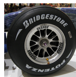
Forgeage : la matière est frappée sans casser les fibres Jante magnésium Très cher - Très solide
