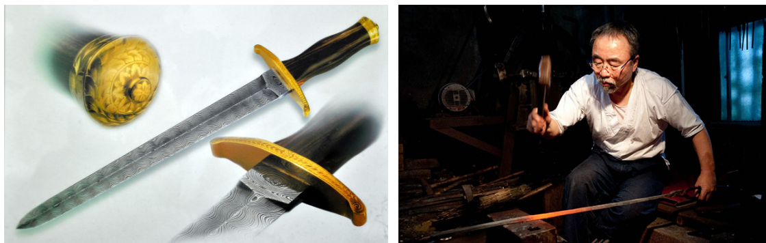
Les lames sont forgées à l'aide d'un marteau.
