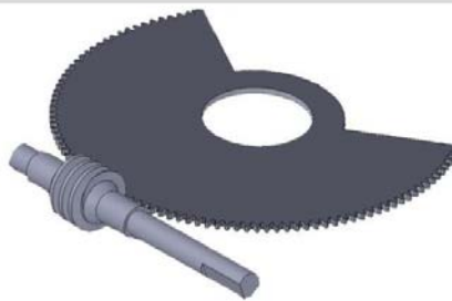
Caractéristiques du second étage de réduction : roue / vis sans fin
