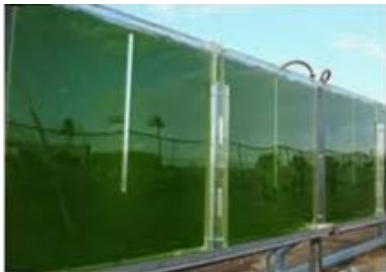
Photobioréacteur plan (Bitog et al., 2011)
