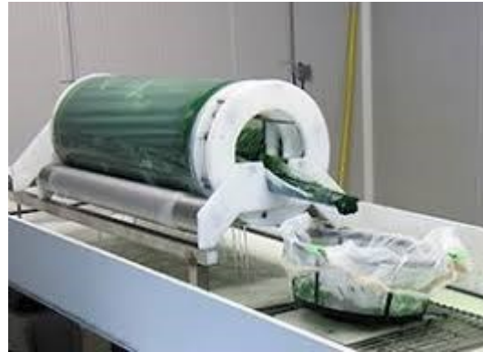
Filtre à tambour : filtration tangentielle
