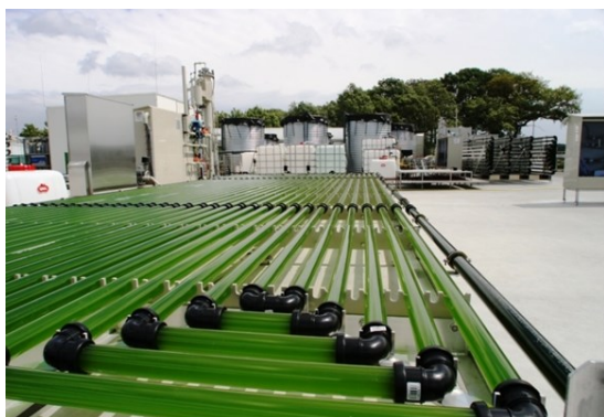
Photobioréacteur tubulaire horizontal (L'actualité chimique - n°381 - janvier 2014)
