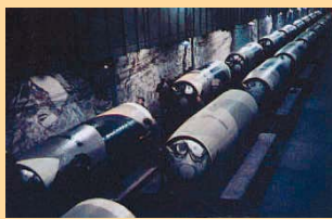
Réservoirs de fusées V2 sur la chaîne de montage (photo SS).
