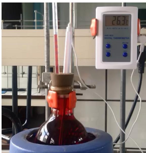
L'enseignant réalise l'expérience de mise en évidence de la dilatation thermique de l'eau (ballon contenant de l'eau colorée, muni d'un bouchon deux trous permettant d'y disposer un fin tube en verre et un thermomètre. Le ballon est chauffé doucement. On observe que le volume occupé par le liquide est d'autant plus grand que sa température est plus élevée.)
