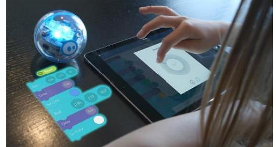
**Figure 15:** commande de SPRK par tablette
