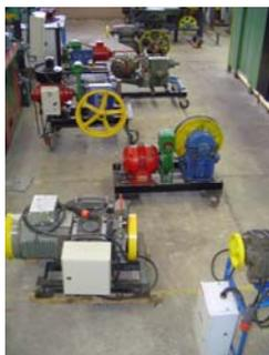
Les treuils sont montés sur châssis mobile. Un coffret contient l'adaptation courant – tension du frein. L'ensemble peut être alimenté par simple prise à partir du coffret mobile d'alimentation
