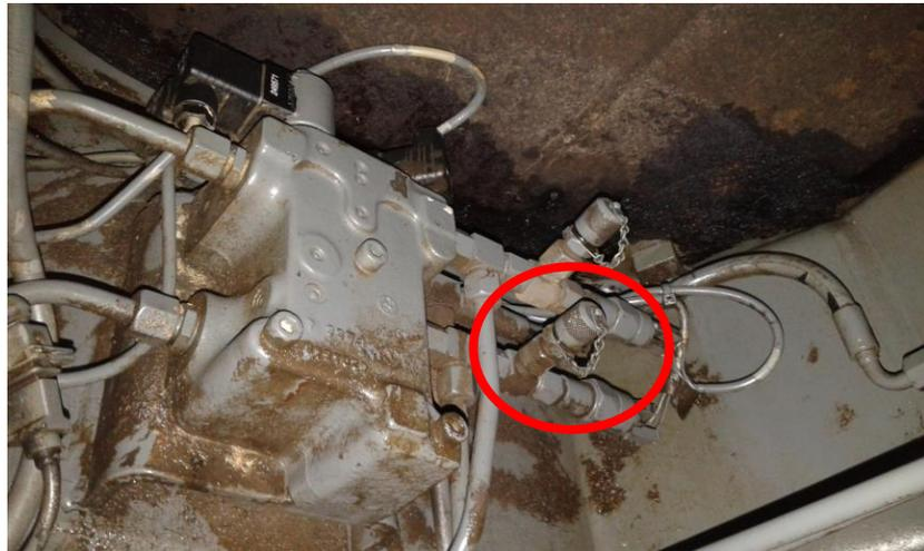
1.2 Débloquer le frein de stationnement à l'aide du bouton poussoir (S16) au tableau de bord illustré ci-dessous, et contrôler la pression à la prise de pression (46)
