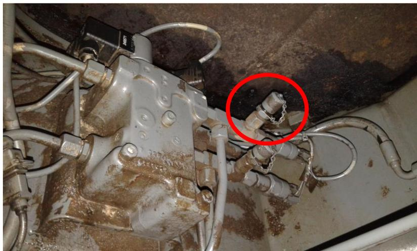
2.2 Enclencher la vitesse 1 puis la vitesse 2 par l'intermédiaire de l'interrupteur (S42) au tableau de bord illustré ci-dessous.
