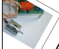
Une rotation de 180° est obtenue en inversant les bornes IN+ et IN- du moteur.
