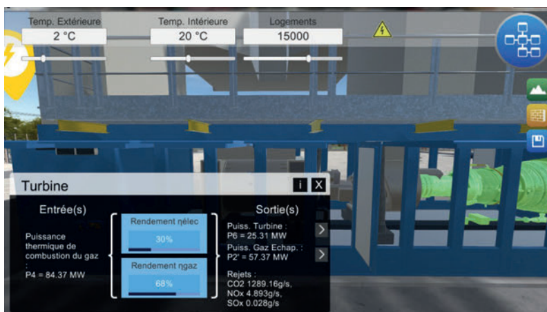
15 La centrale thermique : affichage des variables d'entrée et de sortie par un clic sur l'élément
