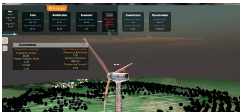
6 Visualisation (en rouge) des éléments soumis à des contraintes anormales
