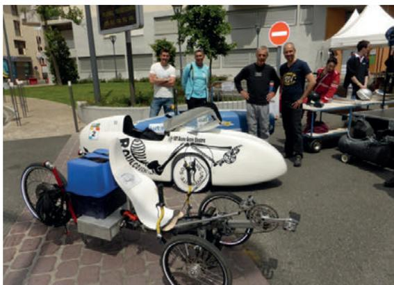
**18** Prototype de tricycle électrique pendulaire avec pneu classique renforcé à faible consommation d'énergie
