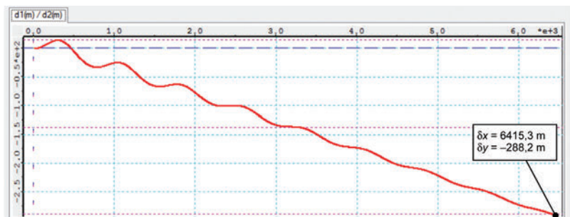
9 Déplacement vertical en fonction du déplacement horizontal (phugoïde amortie)
