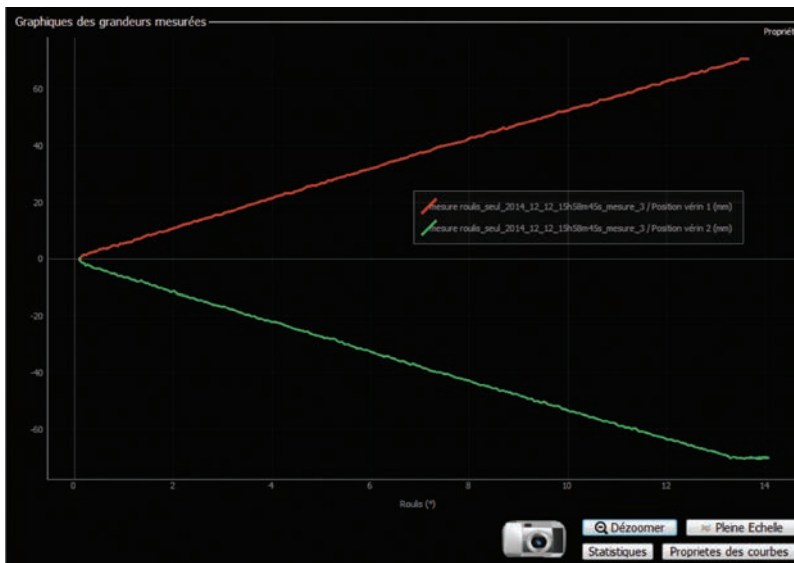
13 La loi de commande identifiée expérimentalement (tracé des déplacements des vérins en fonction de l'angle de roulis)
