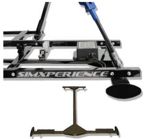
14 La solution de l'implantation d'un 3° axe pour le mouvement de la chasse
