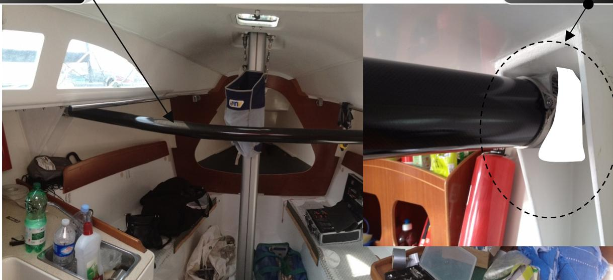
Sur les monocoques, afin de rigidifier cet ensemble, on a souvent recours à une barre de renfort transversale, disposée dans la largeur du voilier, jouant le rôle de barre anti-rapprochement. Sur les voiliers de compétition, la barre est constituée d'un tube en fibre de carbone, pour des raisons évidentes de rapport rigidité/poids.
