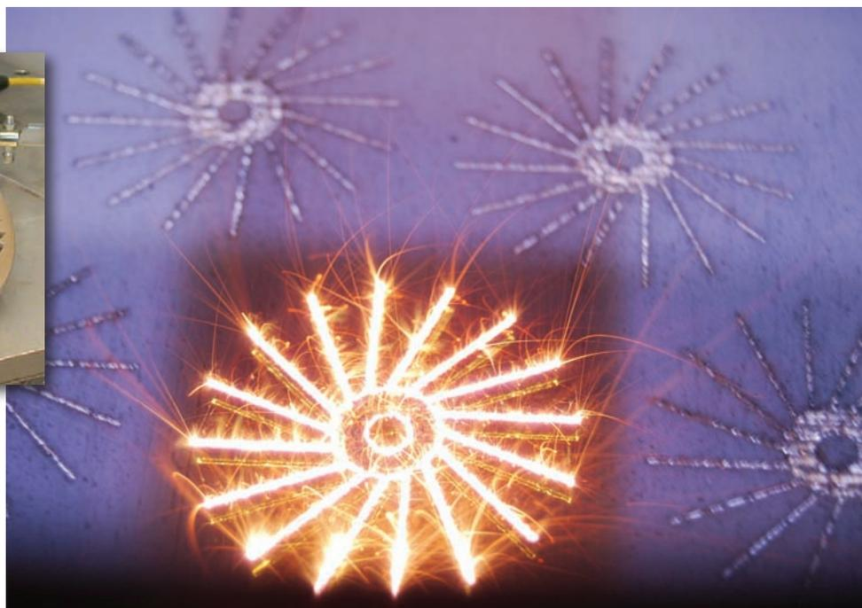
■ Poly-Shape réalise avec sa technologie de fabrication directe par fusion laser des pièces complexes en alliage de titane pour l'aéronautique. De plus, ce procédé permet des délais de production très courts.
