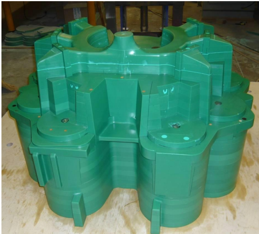
Modèle de filtre à carburant Fonderies Salin / Strat'YM (Planche usinable)
