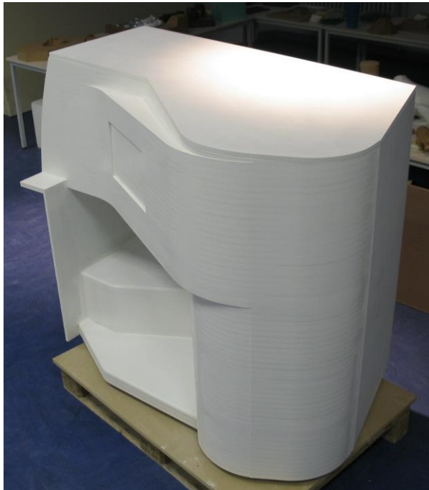
Prototype géométrique pour validation encombrement - aménagement intérieur d'avion ZODIAC AEROSPACE (MDF)
