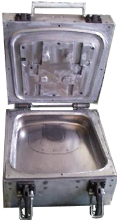
Outillage direct de moussage MECMAS Industrie (Aluminium)
