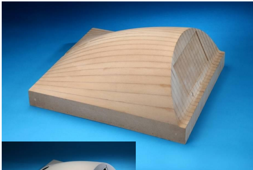
Outillage prototype de thermoformage et pièce Capot Chaudière Projet Strat'ORA (Médium)
