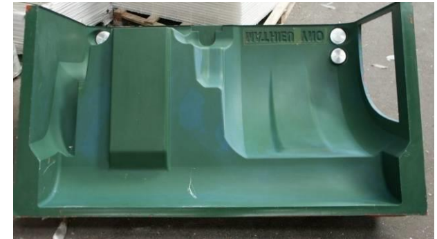
Outillage série de moulage contact PSV
