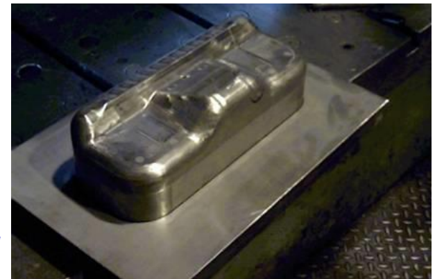
Outillage d'emboutissage Projet CRAFT Fastool (Acier)
