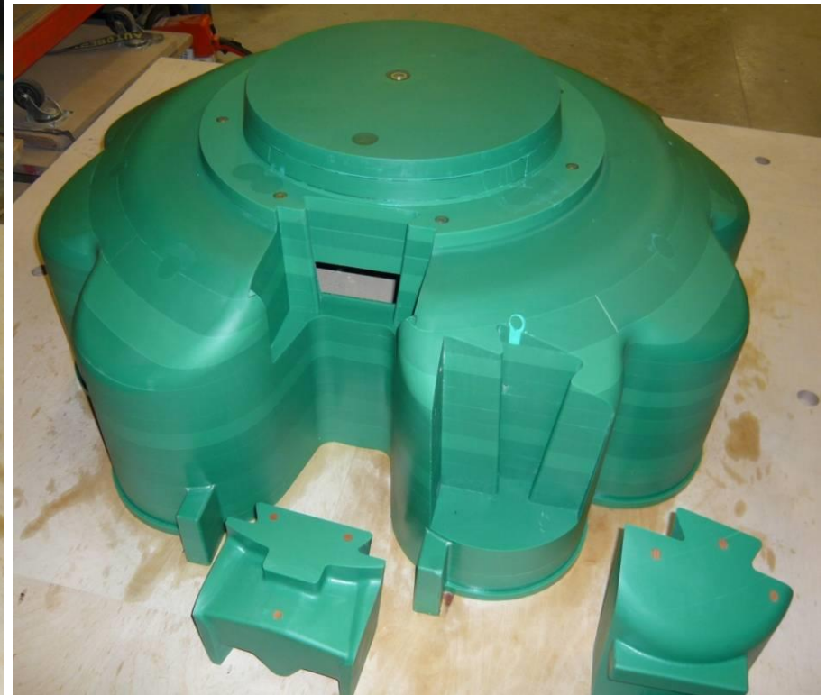
Modèle de filtre à carburant Fonderies Salin / Strat'YM (Planche usinable)
