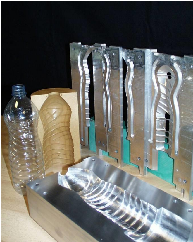
Outillage d'Injection Soufflage Contrat de R&D NESTLE WATERS / CIRTES (Aluminium)
