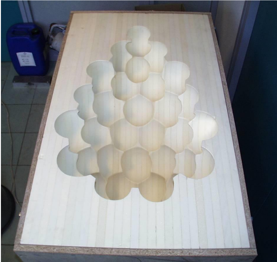
Outillage pour coulée béton Birkenmeyer (Mousse PU)
