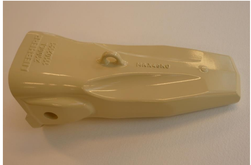
Prototype géométrique d'une dent de godet – Application minière LIEBHERR (résine PU)
