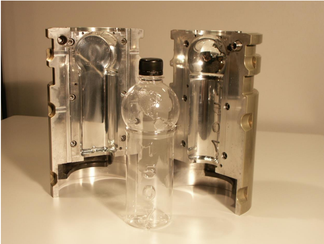
Outillage d'Injection Soufflage Contrat de R&D VEGETAL&MINERAL WATER / CIRTES (Aluminium)
