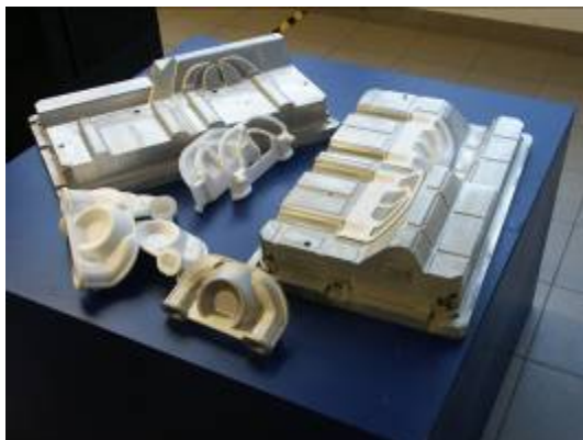
Outillage rapide aluminium pour injection polystyrène - Application PMP CATOIRE SEMI
