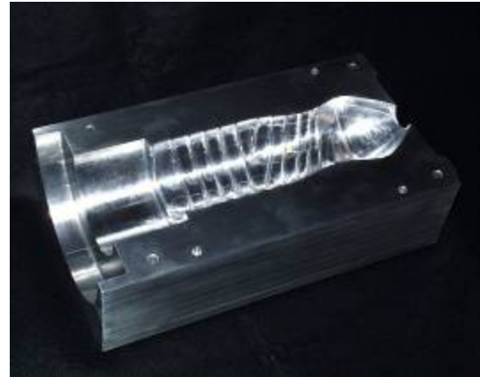
Outillage rapide d'injection soufflage en aluminium Nestlé Waters
