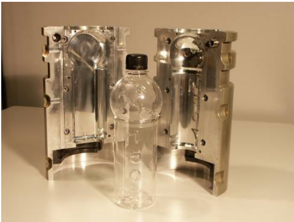
Outillage Rapide de soufflage réalisé par Stratoconception® aluminium
