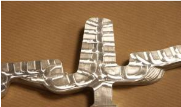
strate avec le passage vapeur intégré
