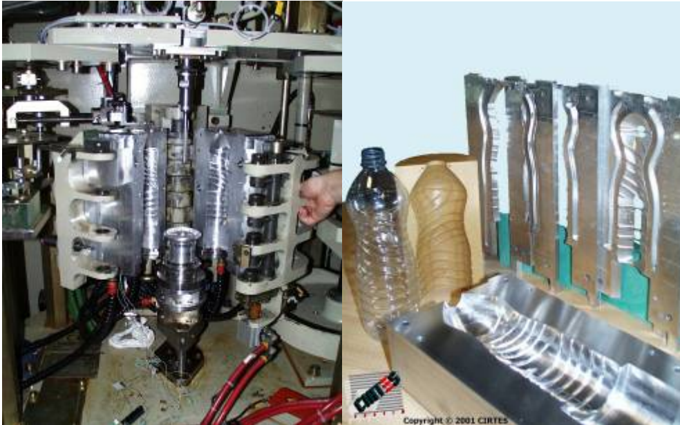
Outil en situation - image de l'outil achevé - quelques strates - une bouteille produite
