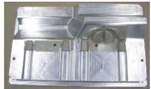
Outillage d'injection polystyrène réalisé en Stratoconception® aluminium
