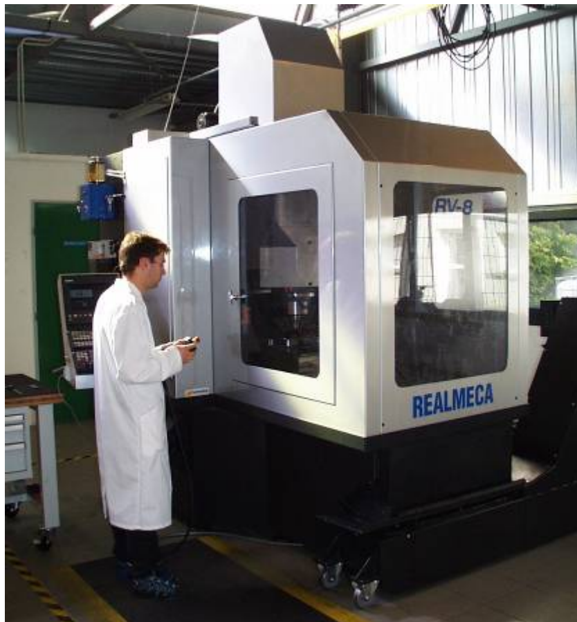
Exemple d'intégration du procédé de Stratoconception® sur machine 3 axes REALMECA RV8 avec commande numérique SIEMENS
