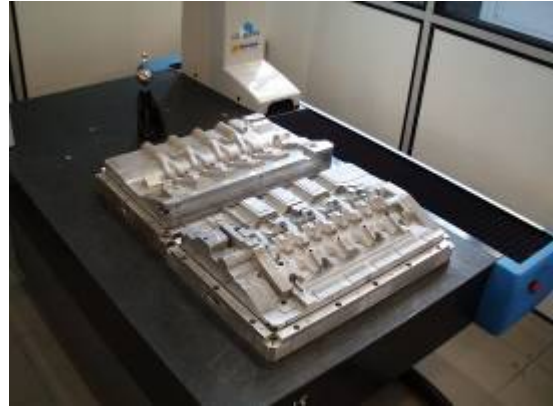
Outillage rapide aluminium pour injection polystyrène - Application PMP PSA
