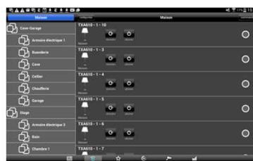
Lorsque le paramétrage est achevé, la configuration peut être transférée automatiquement vers un serveur domovea. Dans ce cas, tous les types d'appareils et ainsi que l'architecture de la maison sont générées.
