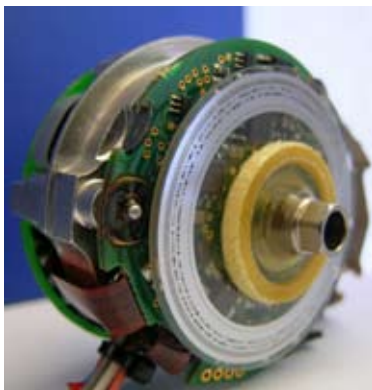
Figure 63 Disque optique d'un codeur incrémental
