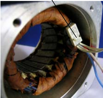
Figure 43 Inclinaison des bobinages du stator d'un servomoteur
