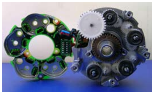
Figure 64 Train de réduction (à droite) et capteurs à effet Hall (à gauche) d'un codeur multitours
