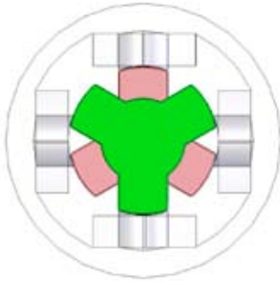
Figure 30 Illustration d'une des positions possibles à l'arrêt du moteur
