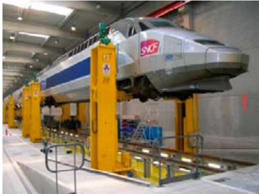
Figure 149 Système de levage d'une rame TGV complète (Document Leroy-Somer)
