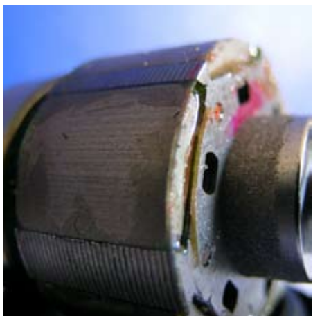
Figure 41 Disposition des aimants périphériques
