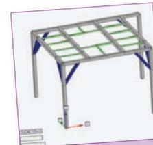
Freelem est un logiciel gratuit de calcul de structure par éléments finis. Il permet le calcul de structures de type poutre,
