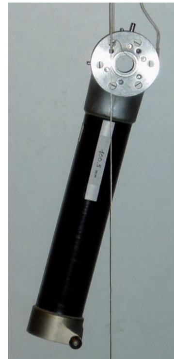
8 Le processus de détermination de la position du centre de gravité dans le plan (y, z)
