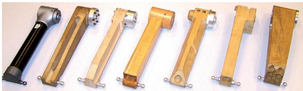
**13** Le bras initial en carbone et tous les prototypes réalisés (de gauche à droite : chêne, hêtre, hêtre, pin, chêne, chêne)
