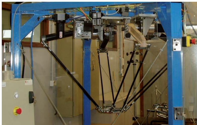
**16** Le test final des prototypes sur le robot pour plusieurs cycles avec une plate-forme de masse 2 kg et des accélérations croissantes jusqu'à 17 g
